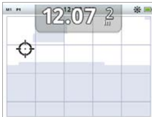
图 9 - 探测界面显示的目标识别面板(上图所示目标Fe读数为12, Co读数为7, 深度为2英寸)
